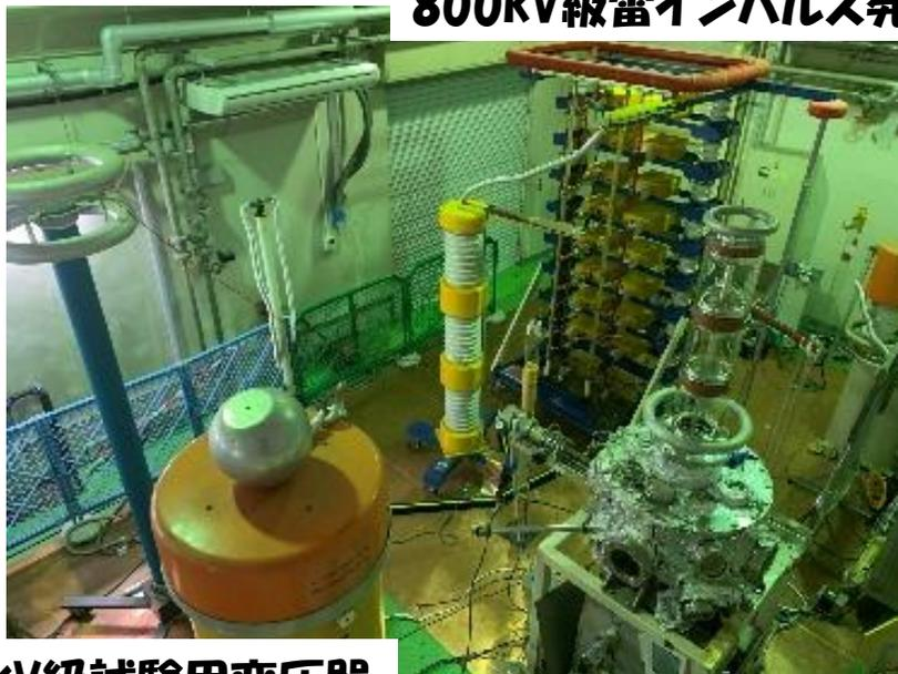
245kV級試験用変圧器
