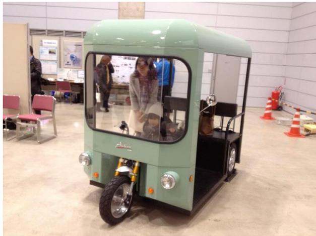
研究室で独自に開発した観光用電気自動車(インホイールモータ搭載、キャパシタ充電により従来のバッテリー搭載時には充電時間が5時間かかるのに対して4分で満充電可能)
