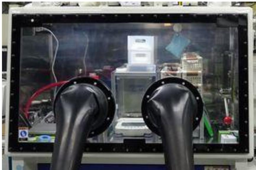
制御グローブボックス:リチウムイオン電池など高エネルギー密度電池の材料は空気や水分に対して不安定なものが多いため、アルゴン雰囲気での電池の作成を行う。
