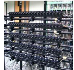
複眼カメラによる 100視点撮影装置 光線空間撮影
