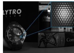
複眼カメラによる 100視点撮影装置 光線空間撮影
