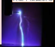
真空中放電による 電極コンディショニング
