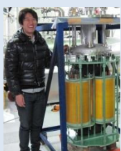
世界初の2MVA級 超電導限流変圧器
