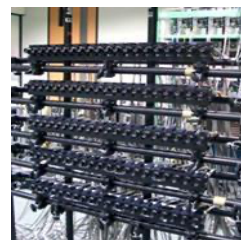
複眼カメラによる 100 視点撮影装置 光線空間撮影
