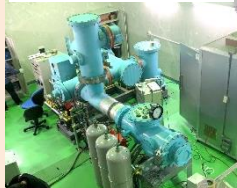
ガス絶縁開閉装置(GIS) 245kV-GIS用FGMスペーサ
