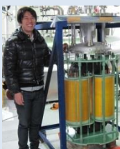
世界初の2MVA級 超電導限流変圧器
