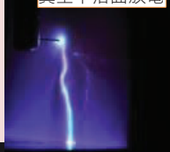
真空中放電による 電極コンディショニング
