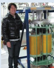
世界初の2MVA級 超電導限流変圧器
