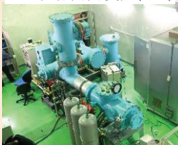
ガス絶縁開閉装置(GIS) 245kV-GIS用FGMスペーサ
