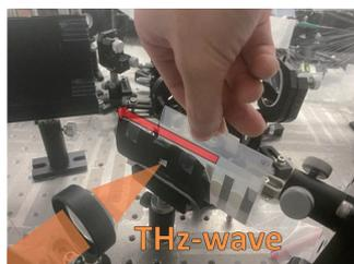
現在、実用的なリアルタイムテラヘルツ測定装置はない。そこで、is-TPGの多波長発生化や、高速波長可変機構の開発によりリアルタイム分光装置を実現した。左図に示すようにサンプルを手でスライドした場合でも、遮蔽物越しにサンプル情報を読み取り可能となった。非破壊検査や、右記のテラヘルツタグ応用などへの利用が期待されている。
