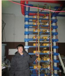
800kV級雷インパルス発生装置
