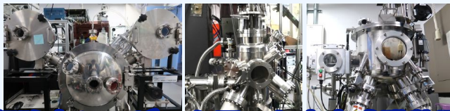
超強力レーザーを用いた真空成膜装置
