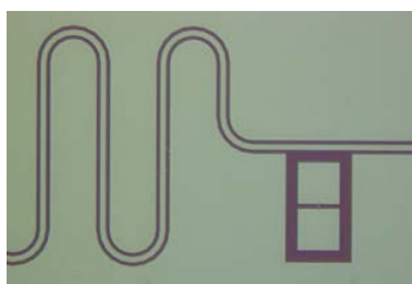
図2 作製した強磁性ジョセフソン素子による超伝導量子コンピュータ素子。
