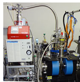
温度可変地場変調ホール効果測定装置
