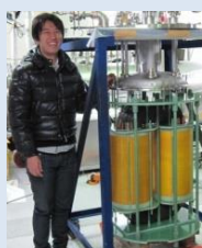
世界初の2MVA級 超電導限流変圧器
