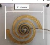
UHFセンサ (スパイラルアンテナ)
